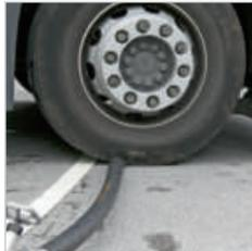
Schlauch- und Kabelbrücken zum Schutz von Kabeln und Schläuchen.
